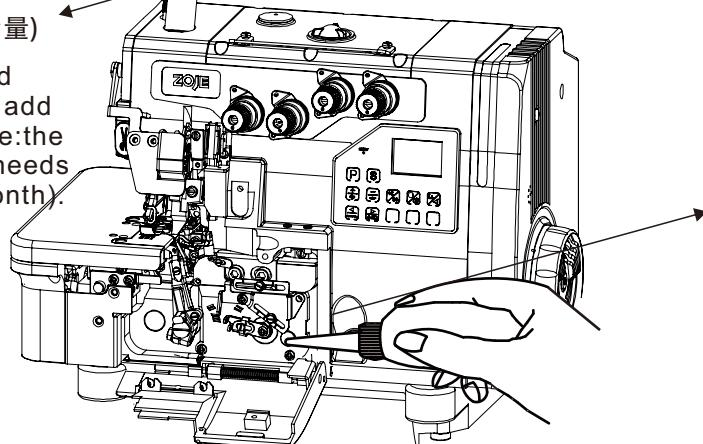
加油时，需打开盖板的盖子，然后向机壳内腔加入油脂。
