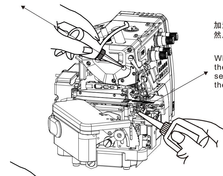
加油时，需打开滑杆座侧边的盖子，然后向滑杆套处加入一点油脂即可。
